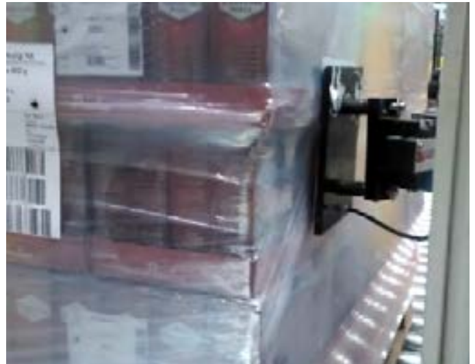
迈思肯公司的 QX-870 光栅激光扫描器可在托盘标签打印后立即验证标签上的条形码
