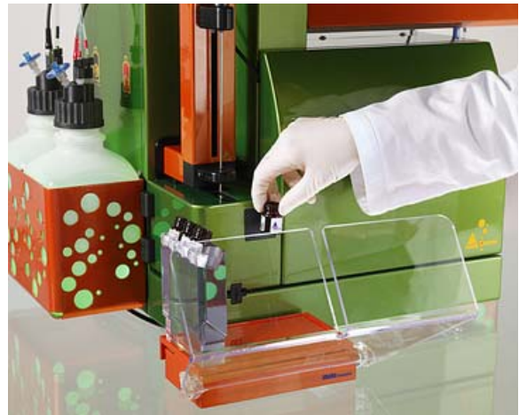
一台二维读码器正在读取试剂瓶上的 Data Matrix 码以简化样品处理过程
