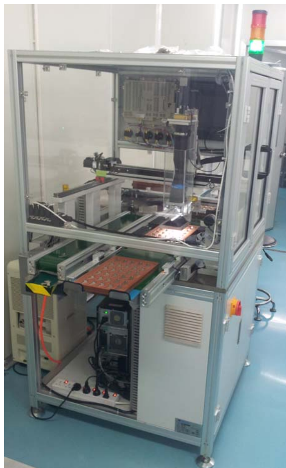
图 2，线扫描视觉系统进行产品成像并分拣
