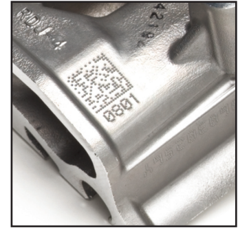
Ilustración 7: Este ejemplo de marcaje directo de piezas muestra un símbolo de matriz de datos de impresión por puntos en un componente metálico.
