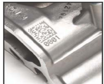
图 7： 直接零件标记样例显示了金属部件上的点刻生成的数据矩阵码
